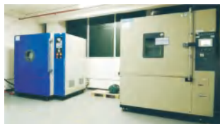
低气压测试箱(左),恒温恒湿测试箱(右)
