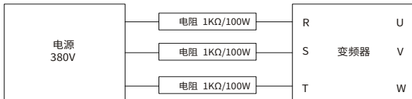
图 9-1 380V 驱动装置充电电路示例
