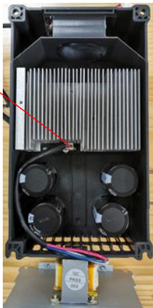
图 6-2 工频变压器拆卸示意图
